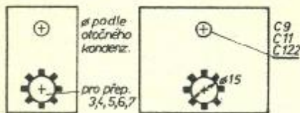
Obr. 2. Přepážky, jimiž prochází přepínač vstupních cívek (vyrobeny z dvoustranné plátované desky pro plošné spoje)
